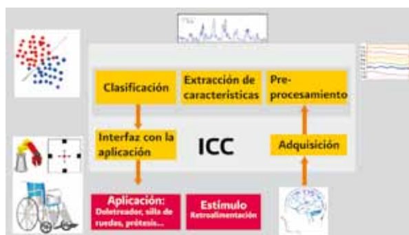
Figura 5. Componentes de una Interfaz Cerebro-Computadora.
