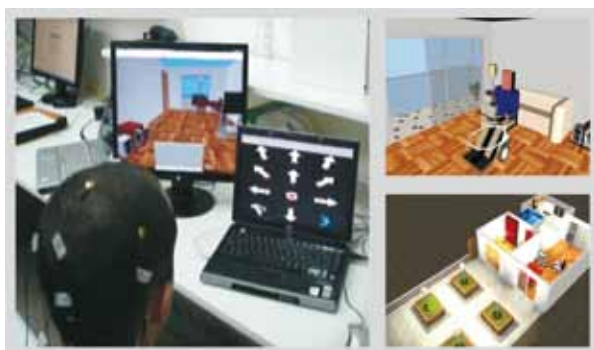
Figura 6. Instalación final de la ICC para control de una silla de ruedas virtual y su ambiente de navegación.
